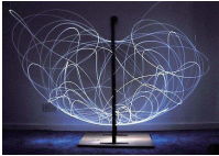
LEDと長時間露光で捉えた実際の二重振り子の動き (Wikipedia:二重振り子より, CC BY 3.0)
